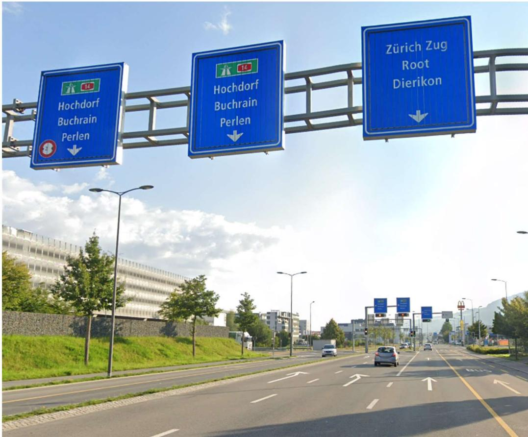
Abbildung 19 Foto einer Einspurtafel über Fahrstreifen auf Hauptstrassen
