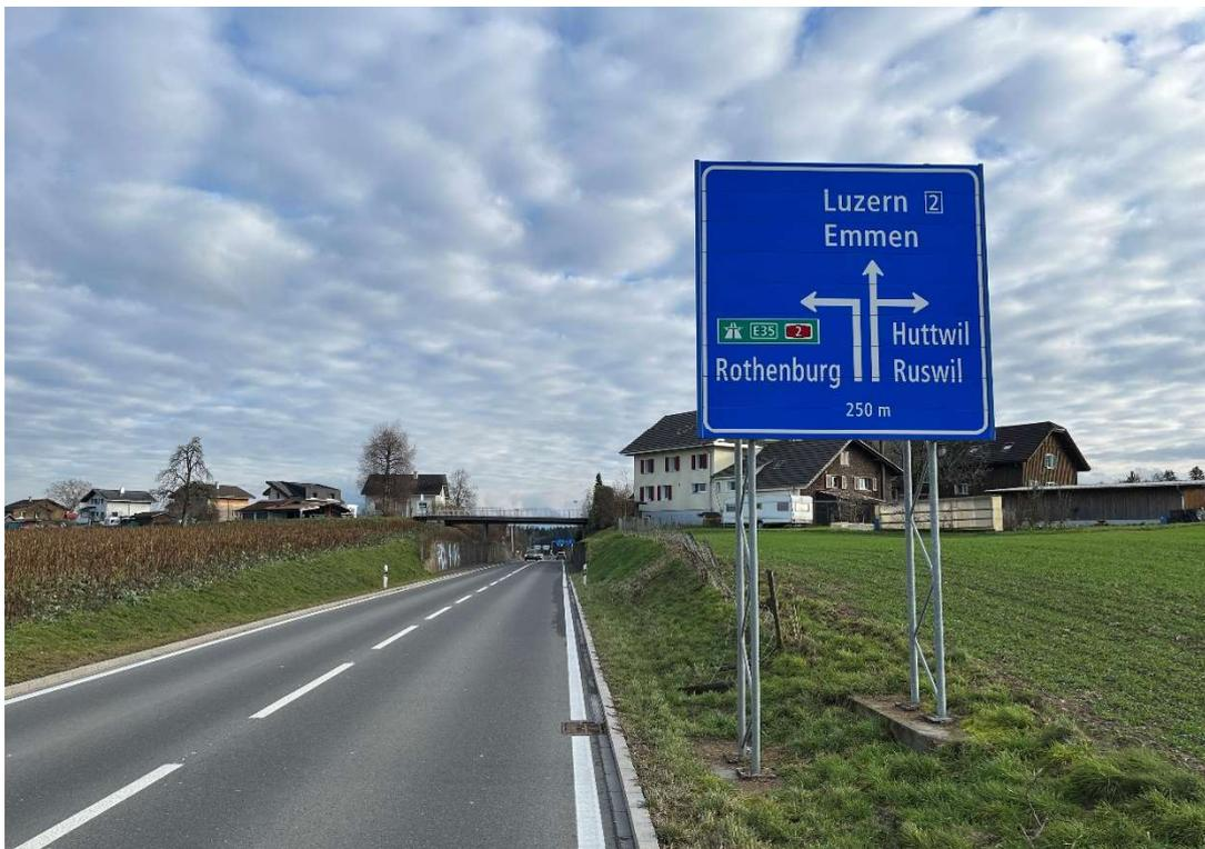
Abbildung 20 Foto eines Vorwegweisers mit Fahrstreifenaufteilung auf Hauptstrassen
