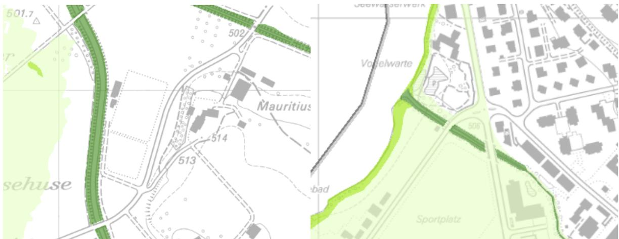
Abbildung 3: Links, im Bereich von Brücken unterbrochene Gewässerläufe -> Wasser fliesst nicht über die Strasse. Rechts, im Bereich der Durchlässe unterbrochener Gewässerlauf -> Wasser fliesst mit schwacher Intensität über die Strasse.
