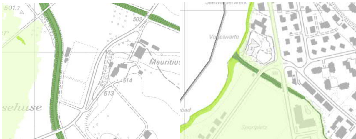
Abbildung 3: Links, im Bereich von Brücken unterbrochene Gewässerläufe -> Wasser fließt nicht über die Strasse. Rechts, im Bereich der Durchlässe unterbrochener Gewässerlauf -> Wasser fließt mit schwacher Intensität über die Strasse.
