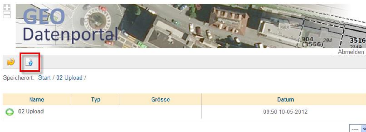
Abbildung 5: Upload-Bereich. Über den Buton (rotes Quadrat) kann das überarbeitete Operat hochgeladen werden. Format: fGDB als Archivformat zip.
