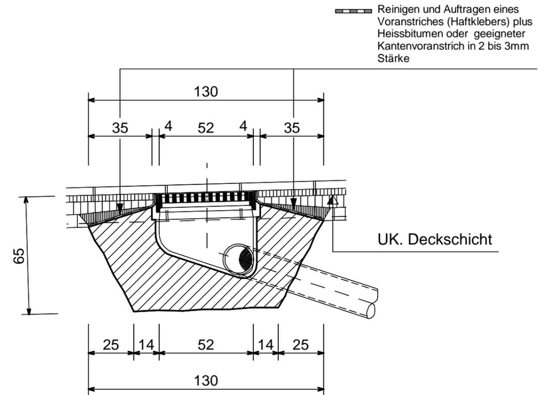
Aushub in verdichteter Fundationsschicht ca. 0.550 m<sup>3</sup>
