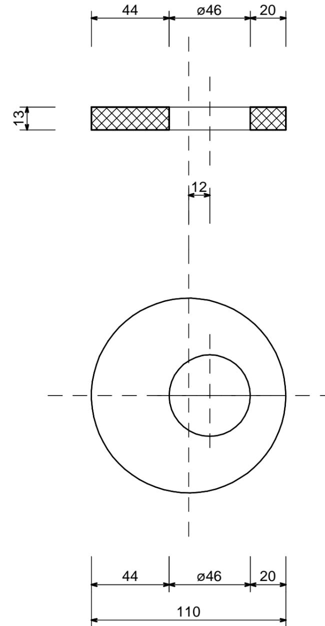
\* Typ entspricht z. B. Creabeton F 3002 Betonkragen Typ ER Art. Nr. 117 253 oder gleichwertig.
