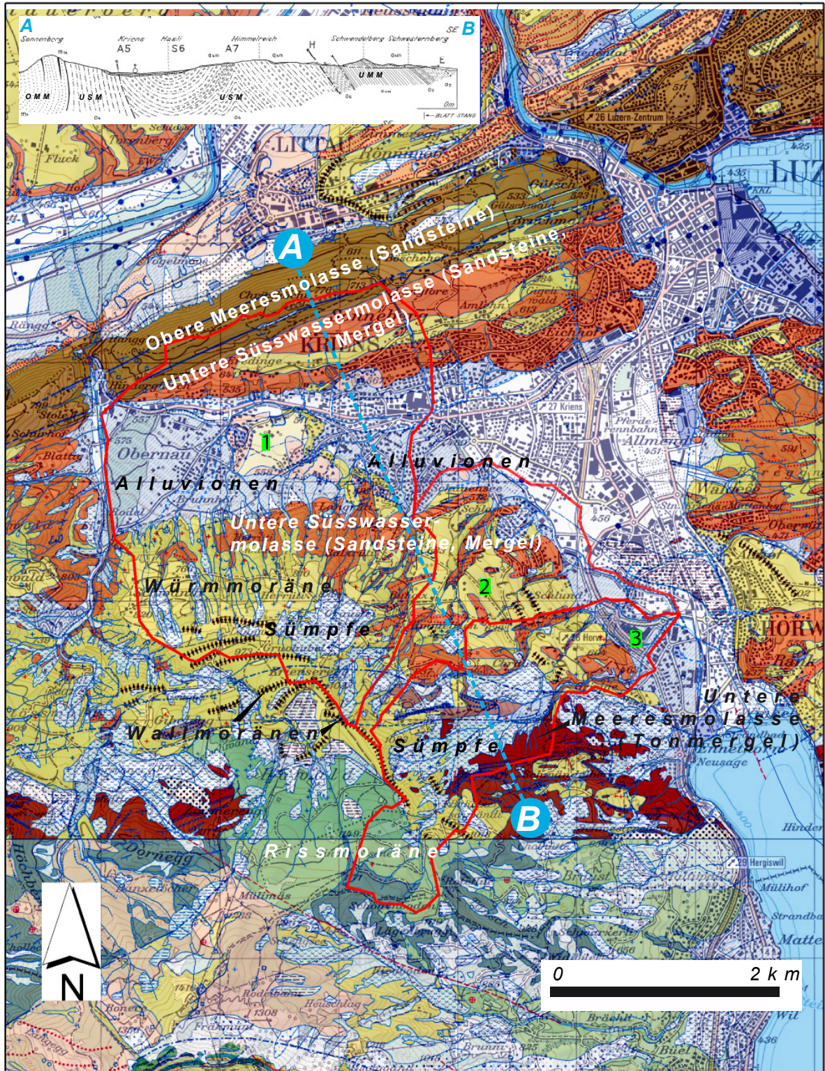
Anhang 4.1: Die geologische Karte (Bundesamt für Landestopographie, 2015) mit den Einzugsgebieten (1: Krienbach, 2: Schlossbach, 3: Steinibach) und den eingezeichneten geologischen Formationen. Die eingezeichnete Profillinie (A-B) ist oben als Schnitt abgebildet (Kopp, 1962) und zeigt die komplexe Lagerung der Schichten in der Subalpinen Molasse.
