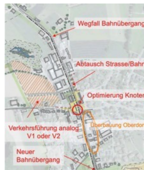
V3 Trasseetausch Bahn-Strasse
