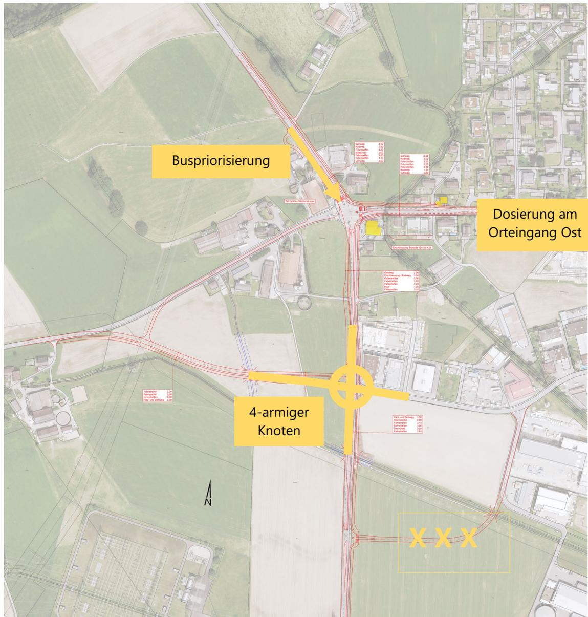
Abbildung 15 Auszug Variante Oberhofen Ost mit Verlegung Mettlenstrasse gemäss ZMB
