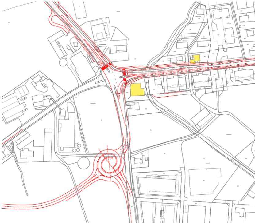
Abbildung 14 Oberhofen Ost mit Verlegung Mettlenstrasse und Turbokreisel
