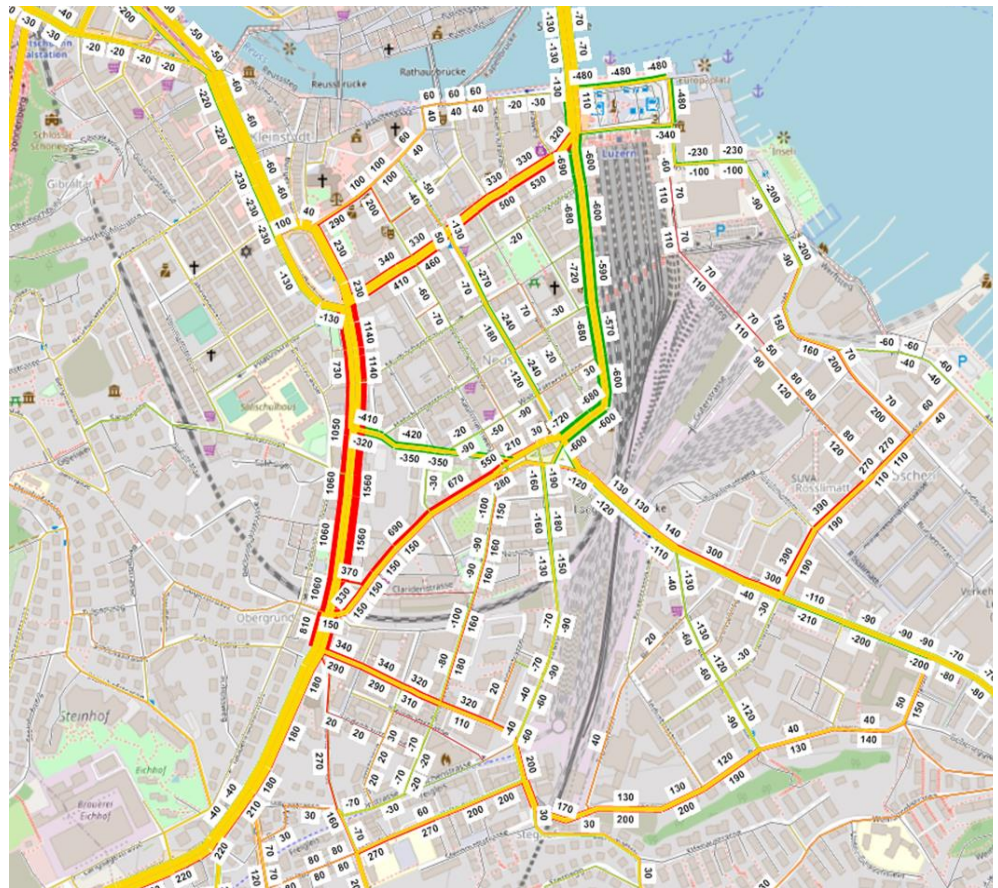
Abb. 11 Wirkungsanalyse MIV Massnahmen (mit Sperrung Hirschmattquartier)
