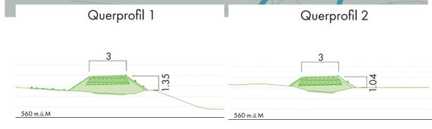
Der Spechtweg oberhalb der Gebäude wird angehoben und bildet einen Damm. Das Wasser wird leicht aufgestaut und über eine Rohrleitung in den Krienbach geleitet.
