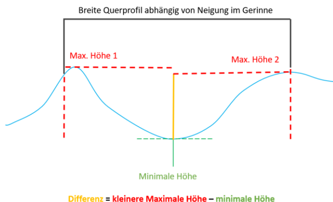
Abbildung 3: Bestimmung der Höhendifferenz zwischen der Gerinnesohle und dem Uferbereich zur Ausscheidung der reliefbedingten Schwachstellen.
