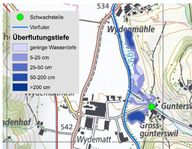
Abbildung 16: Bereinigte Überflutungsflächen. Überflutungsflächen westlich der Wigger wurden gelöscht. (Quelle Kartenhintergrund: Bundesamt für Landestopografie).
