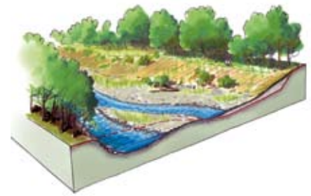
Bild 5. typisches Querprofil im aufgeweiteten Bereich (projektierter Endzustand).
