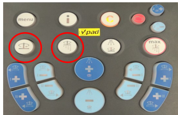
8) Starte den Streueinsatz durch das Einschalten des Streutellers und der Schnecke.
